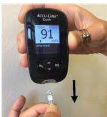
12. 得到測試結果後，拉出測試條即可關閉血糖機
